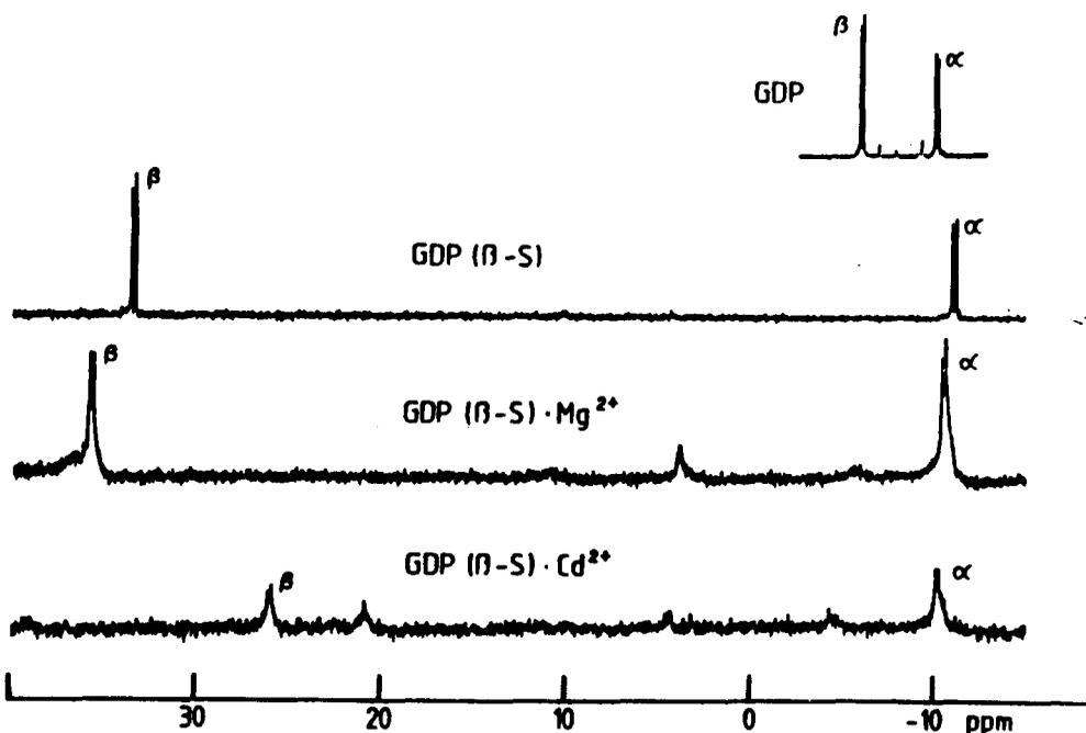
FIG. 8.  $^{31}\text{P}$  NMR spectra of (top to bottom): GDP-GDP( $\beta$ -S)-GDP( $\beta$ -S) $\cdot\text{Mg}^{2+}$ -GDP( $\beta$ -S) $\cdot\text{Cd}^{2+}$  (from: Rösch *et al.*<sup>(40)</sup>).
